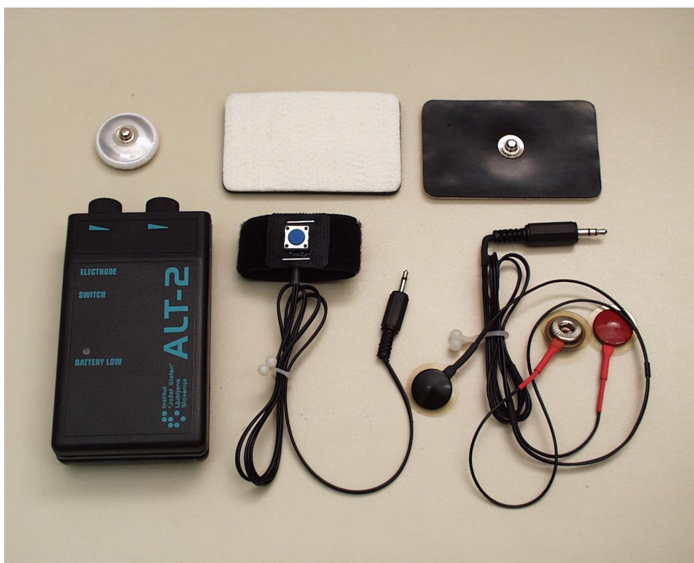
Figura 1: Il set completo dello stimolatore con gli elettrodi da impregnare nell'acqua, i cavi per gli elettrodi e l'interruttore manuale.
