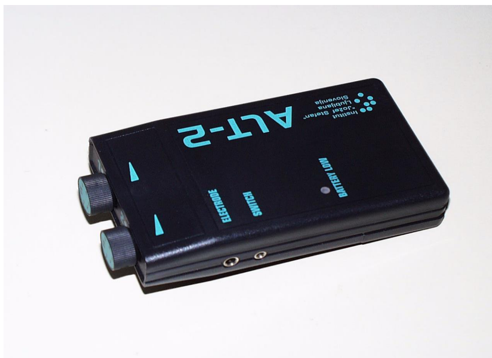
Figura 3: Lo stimolatore ALT-2 con i pomelli per la regolazione dell'intensità e le prese per il connettore degli elettrodi (ELECTRODE) e per il connettore dell'interruttore manuale (SWITCH).
