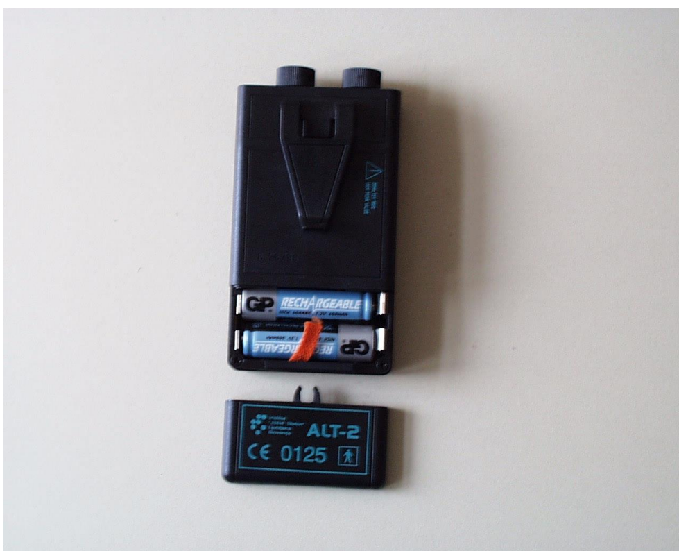
Figura 5: Lo stimolatore ALT-2 con aperto l'alloggiamento delle batterie e vista sul loro giusto posizionamento.
